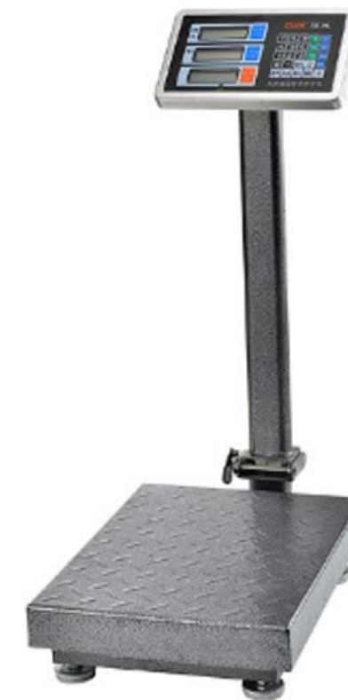
รูปที่ 1.21 ตาชั่งน้ำหนักที่ใช้โหลดเซลล์แบบ Bending Beam [19]
