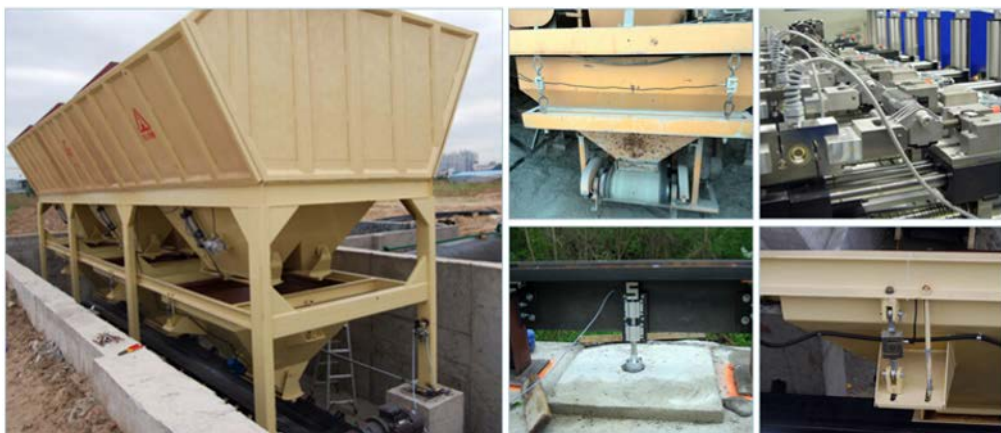
รูปที่ 1.27 ลักษณะการติดตั้งโหลดเซลล์ S beam ที่เครื่องชั่งวัสดุ [25]
