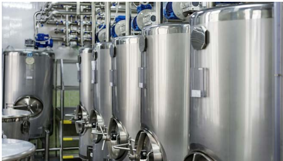
รูปที่ 1.16 ถังบรรจุที่ติดตั้งโหลดเซลล์เพื่อชั่งน้ำหนัก[14]
