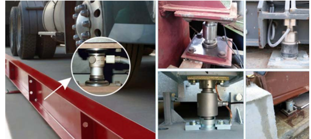
รูปที่ 1.25 ลักษณะการติดตั้งโหลดเซลล์แบบ Canister เครื่องชั่งน้ำหนักรถบรรทุก [23]
