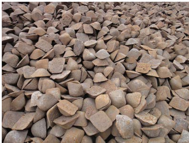
รูปที่ 2.4 เหล็กดิบหรือเหล็กพิกที่ได้จากการถลุงแร่เหล็ก [4]
